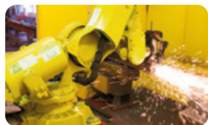
полностью автоматизированный процесс удаления усиления сварного шва по всему периметру рельса
