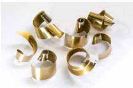
リンジガー社製リング削正車による削正屑は100%リサイクル可能
