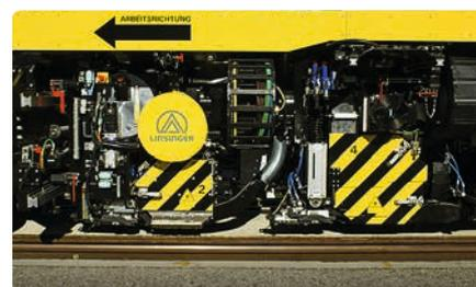
Фрезерный агрегат со смонтированным вслед за ним шлифовальным агрегатом обеспечивают максимальное качество обработанной поверхности рельса
