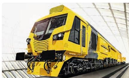
Машина MG31 Обработка рельсов магистральных путей с высокой скоростью
