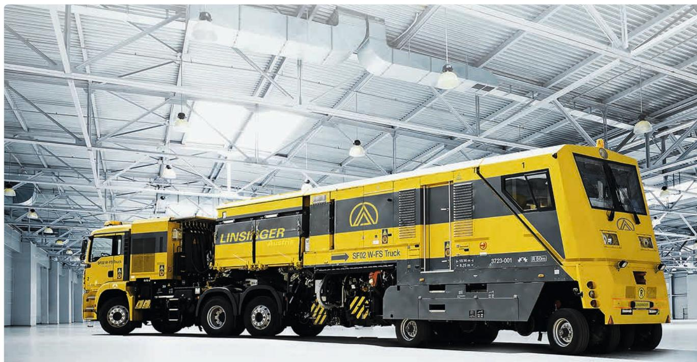
**EFFIZIENT UND LEISTUNGSSTARK** Der Rail-Road-Truck ist ein Multitalent unter den Schienenbearbeitungsmaschinen. Die geniale Zwei-Wege Konstruktion ermöglicht ein einfaches Überstellen und überall mögliches Ein- und Ausgleisen der Maschine. Bestens geeignet für kleine Baulose, sowie zum Einsatz in U-Bahnen und Straßenbahnnetzen.
