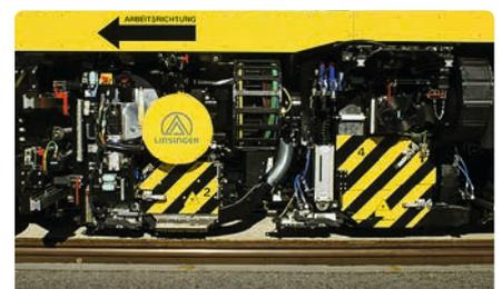
Fräseinheit mit nachgeschalteter Umfangsschleifeinheit für höchste Oberflächenqualität
