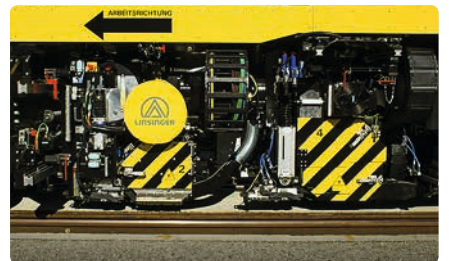
铣削单元和打磨单元带来最高的表面质量
