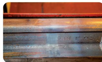
сварной шов после обработки
