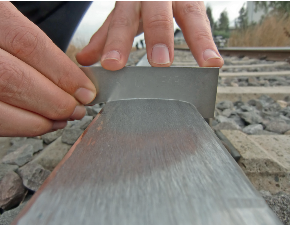
Abb. 1: Schienenoberfläche nach der Neulagenbearbeitung
