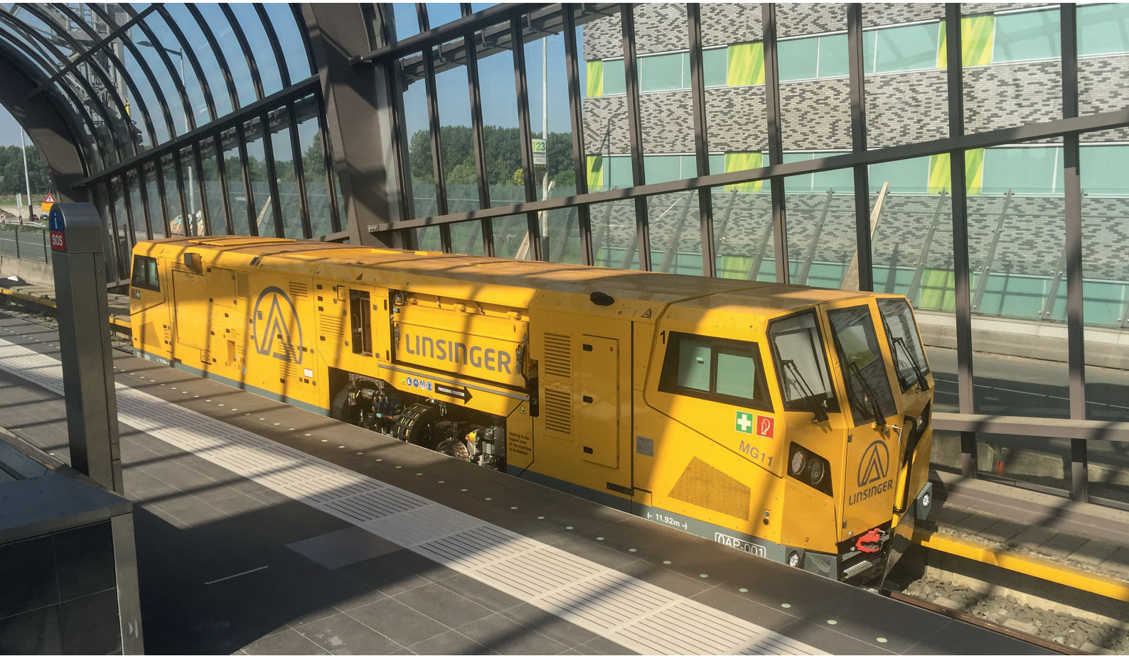
Abb. 3: Linsinger Schienenfräse MG11 im Einsatz bei GVB
